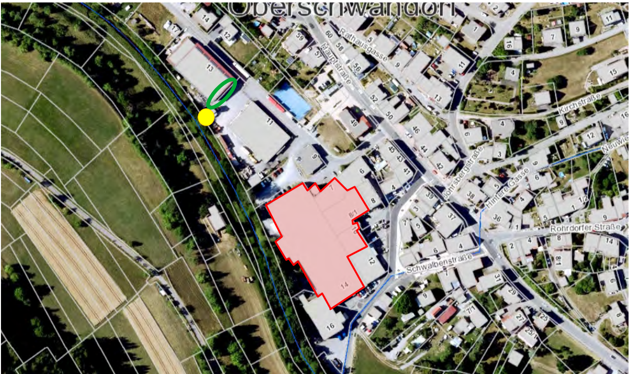
Abb. 13: Lage des ermittelten Quartiers (grün umrandet) sowie des Trafo-Häuschen (gelber Punkt) zum untersuchtem Gebäudekomplex (rot umrandet)
